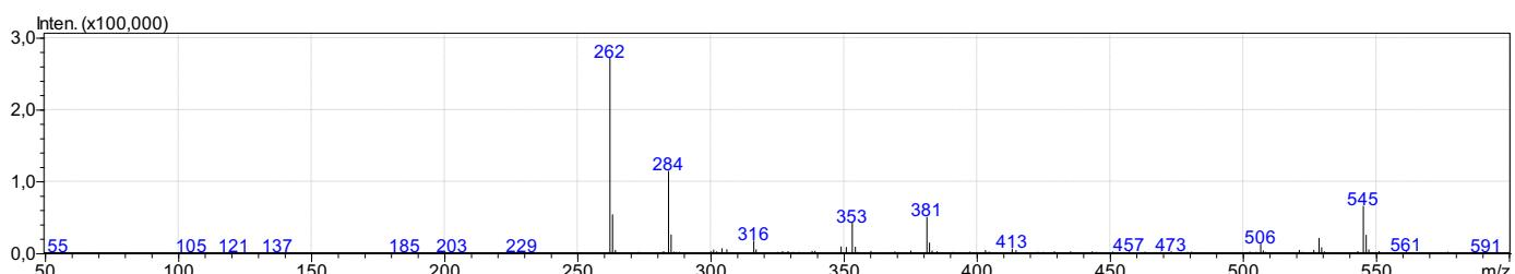
**Slika 58.** MS spektar 2-((2-(*p*-tolil)hidrazinilidin)metil)kinolin (**15**)
