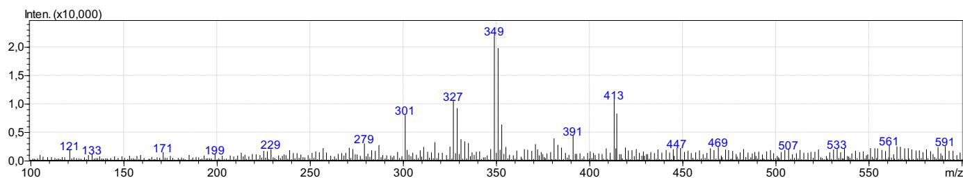
**Slika 46.** MS spektar 4-((2-(2,4-dinitrfenil)hidrazinilidin)metil)-5-(hidroksimetil)-2-metilpiridin-3-ol (2)
