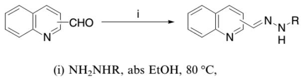
**Slika 13.** Sinteza hidrazonskih derivata 2-kinolinkarbaldehida i 4-kinolinkarbaldehida [8].
