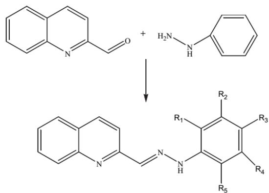
**Slika 14.** Sinteza hidrazonski derivata 2-kinolinkarbaldehida<sup>[9]</sup>.
