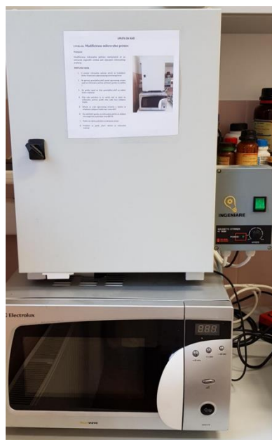
Slika 23. Modificirana kućna mikrovalna pećnica marke Electrolux EMS 2105.
