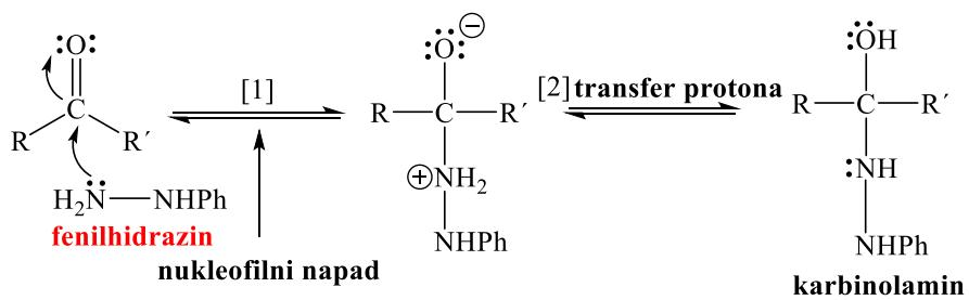
**Slika 6.** Prvi reakcijski stupanj u mehanizmu nastajanja fenilhidrazona <sup>[4]</sup>.
