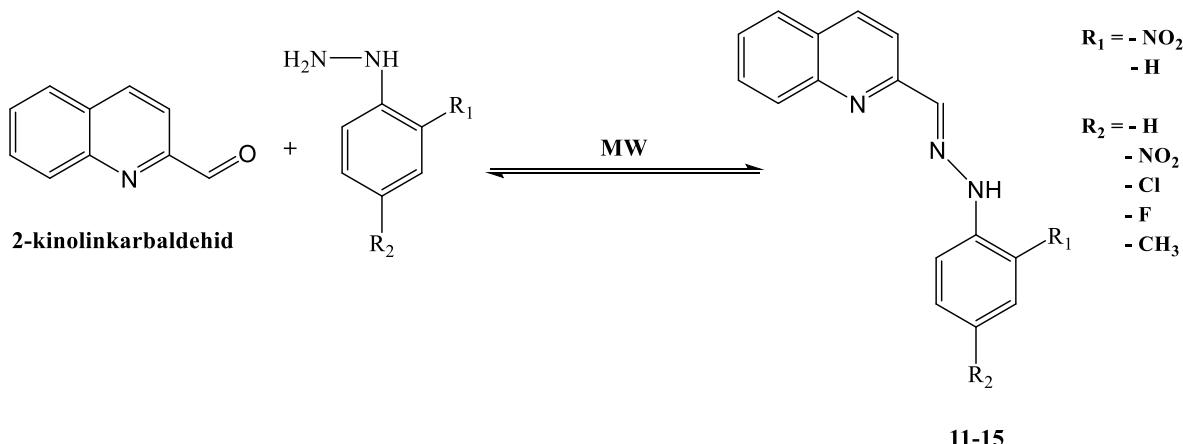
**Slika 26.** Shema reakcije priprave hidrazonskih derivata 2-kinolinkarbaldehida.
