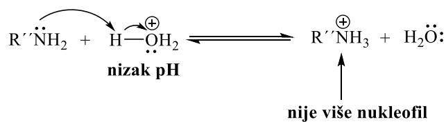
*Slika 8.* Protoniranje amina jakom kiselinom<sup>[4]</sup>.
