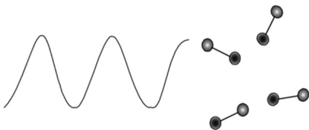
**Slika 20.** Mikrovalno zagrijavanje mehanizmom dipolarne polarizacije [15].
