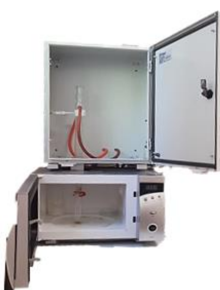
Slika 23. Modificirana kućna mikrovalna pećnica marke Electrolux EMS 2105.
