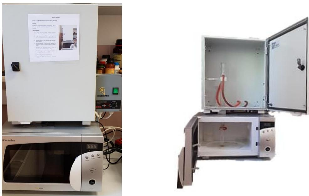
***Slika 23.*** Modificirana kućna mikrovalna pećnica marke Electorlux EMS 2105.
