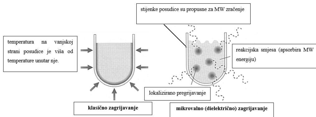
**Slika 22.** Shematski prikaz klasičnog i mikrovalnog zagrijavanja <sup>[14]</sup>.
