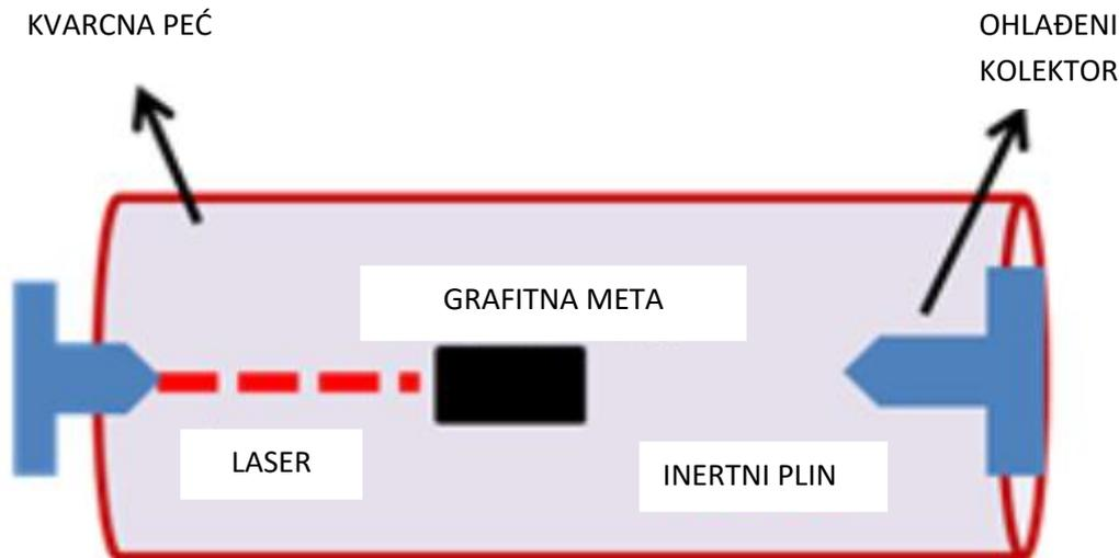
Slika 5. Shematski prikaz laserske ablacije [25]
