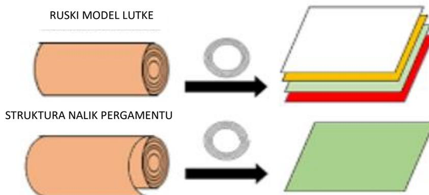
Slika 3. Strukture MWCNT [12]
