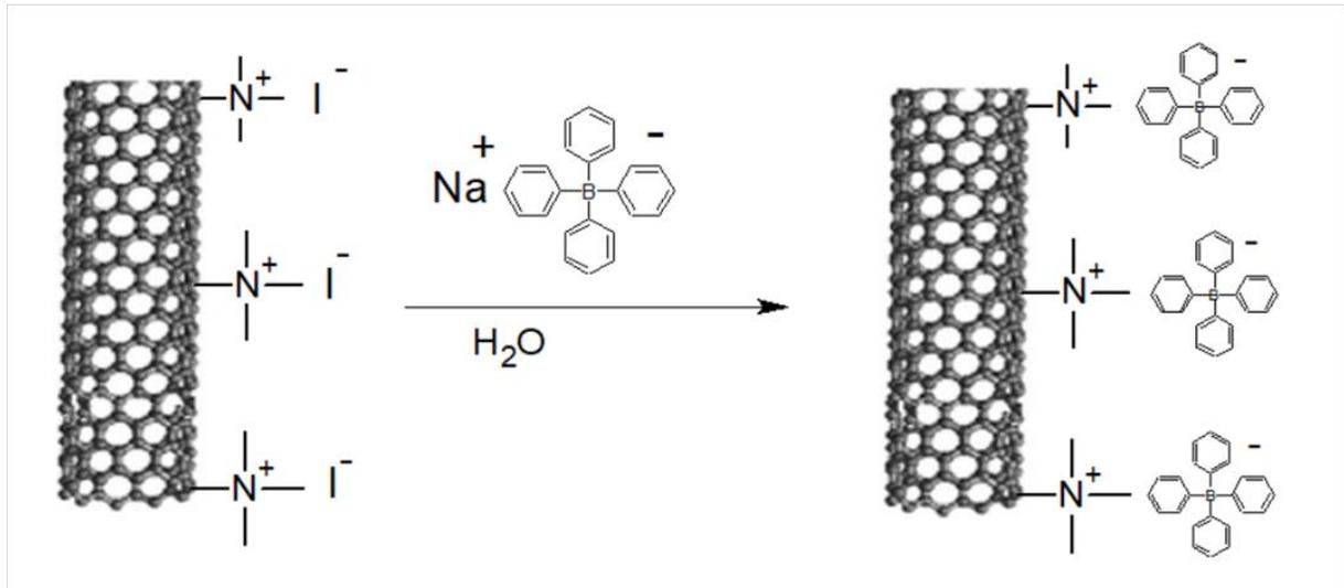
Slika 12. Shema stvaranja ionskog kompleksa za potenciometrijsku detekciju anionskih tenzida
