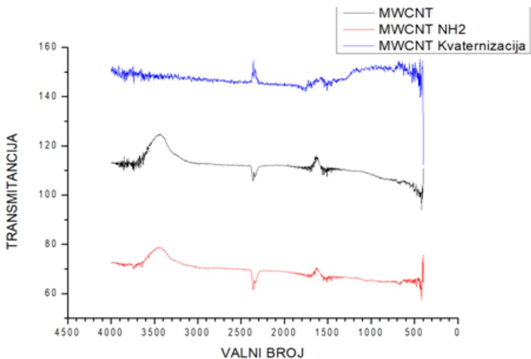
Slika 11. FTIR spektri nefunkcionaliziranih MWCNT (crno), komercijalno dostupnih NH<sub>2</sub> funkcionaliziranih MWCNT (crveno) i pokušaj kvaternizacije komercijalno dostupnih NH<sub>2</sub> funkcionaliziranih MWCNT (plavo)
