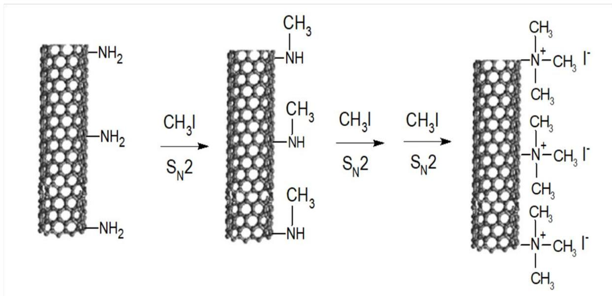
Slika 10. Pretpostavljeni sintetski plan nastanka kvaterniziranih MWCNT
