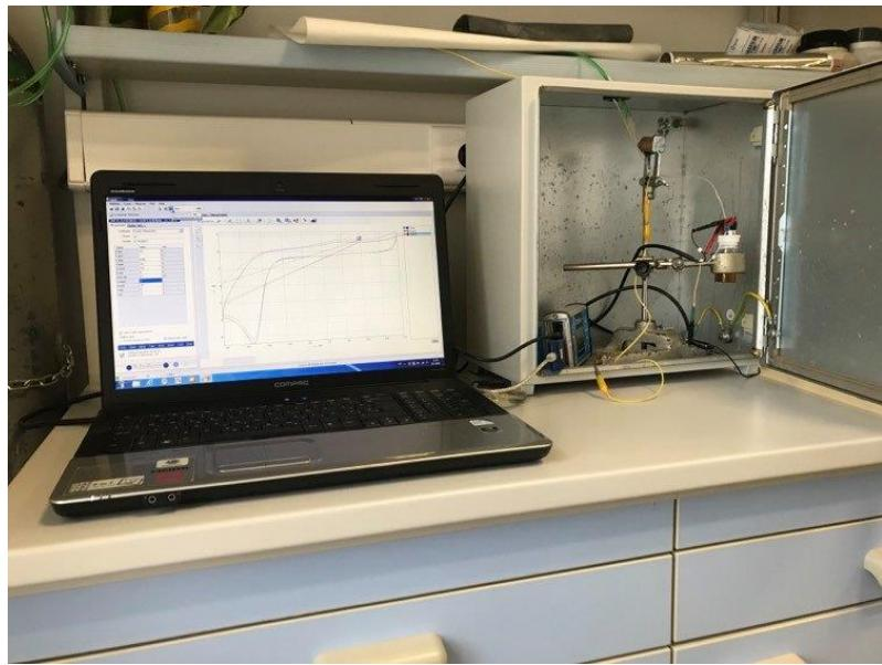
**Slika 29.** Potencijostat/Galvanostat PalmSens uparen s računalnim programom PSTrace 4.2 korišten za elektrokemijska mjerena.
