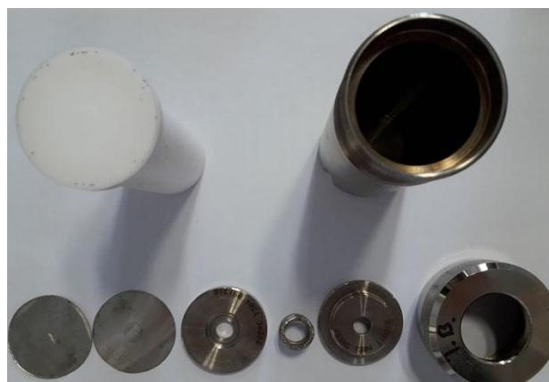
**Slika 25.** Dijelovi hidrotermalnog reaktora (autoklava).
