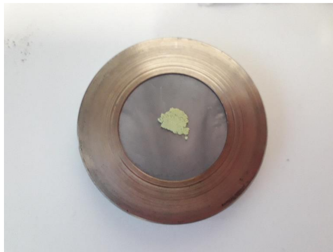
Slika 32. Silikonski nosač uzoraka.
