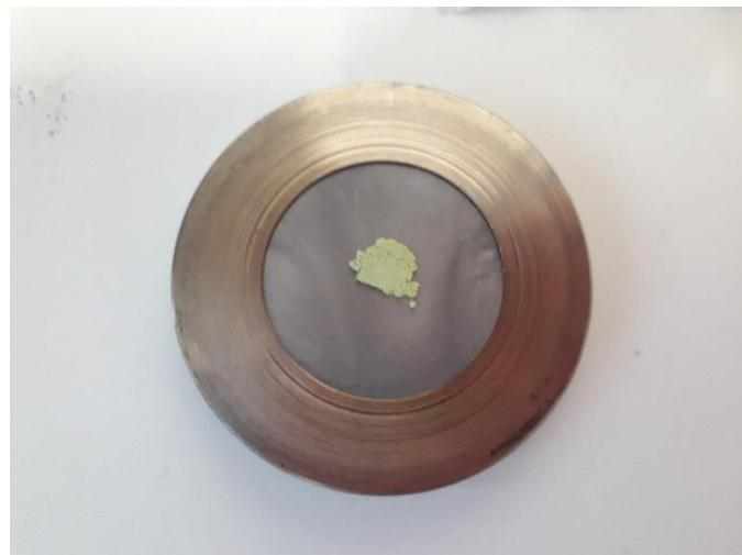
**Slika 32.** Silikonski nosač uzoraka.
