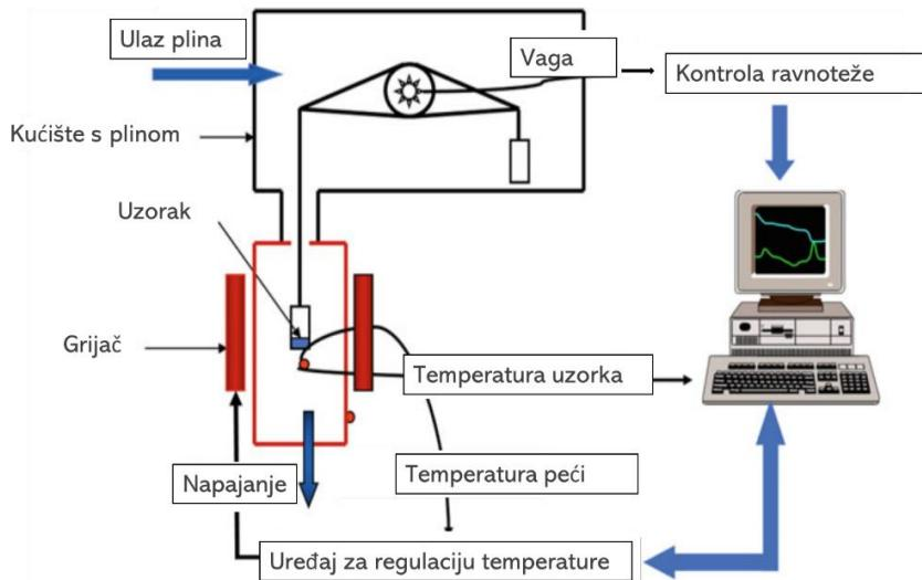
**Slika 16.** Shematski prikaz termogravimetrijskog uređaja [38].
