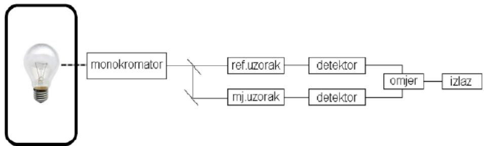
**Slika 23.** Shematski prikaz dvosnognog spektrofotometra.
