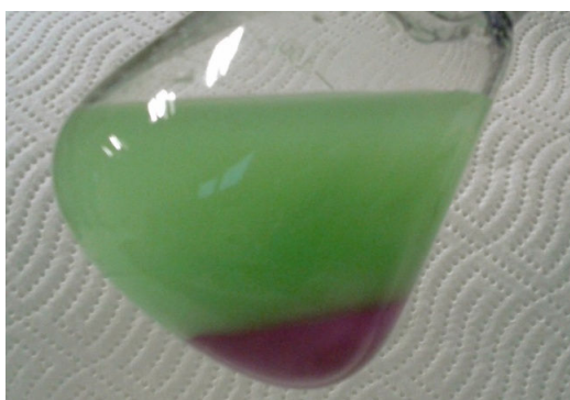
Slika 8: Sredina titracije kada je dodana određena količina Hyamina 1622
