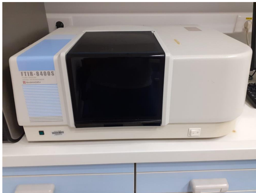
Slika 24. Uređaj za IR spektroskopiju.
