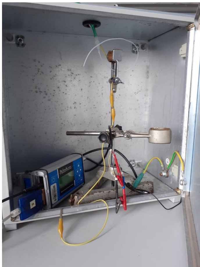
Slika 27. Potenciostat/galvanostat korišten za cikličku voltametriju.
