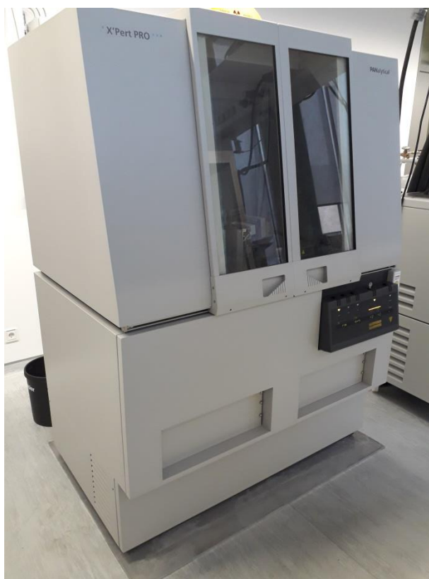
Slika 23. Instrument korišten za rentgensku difrakciju na prahu.
