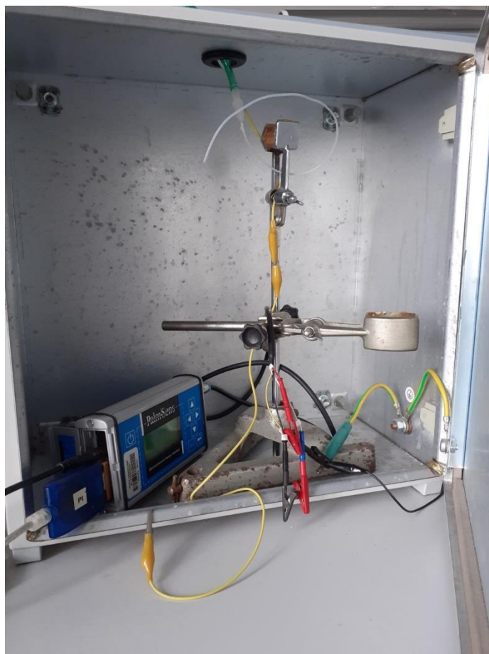
Slika 27. Potenciostat/galvanostat korišten za cikličku voltametriju.
