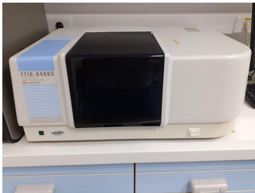
Slika 24. Uređaj za IR spektroskopiju.
