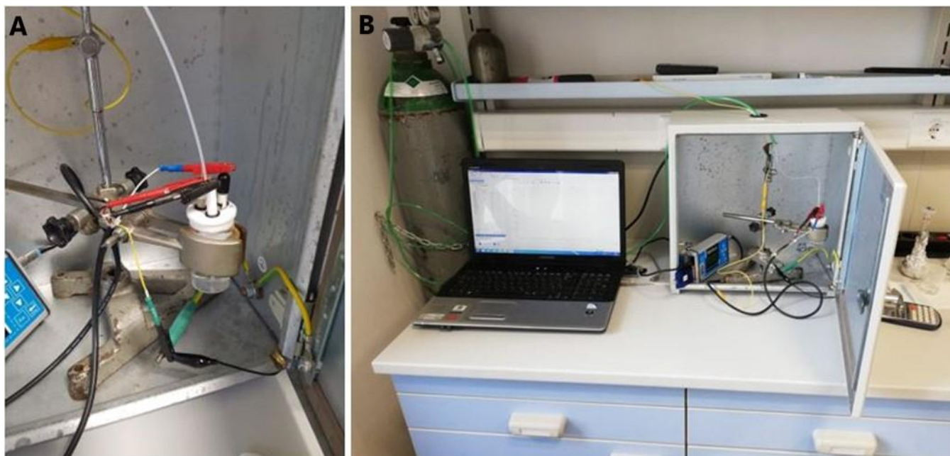
Slika 16. A) Troelektrodna voltametrijska ćelija, B) PalmSens potenciostat/galvanostat.
