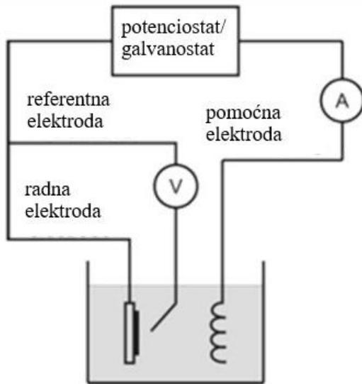
Slika 6 . Shema troelektrodne voltametrijske čelije [26].
