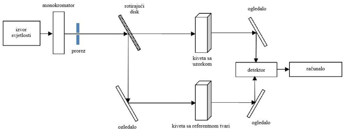
Slika 14. Shematski prikaz dvosnognog UV-VIS spektrometra [42].
