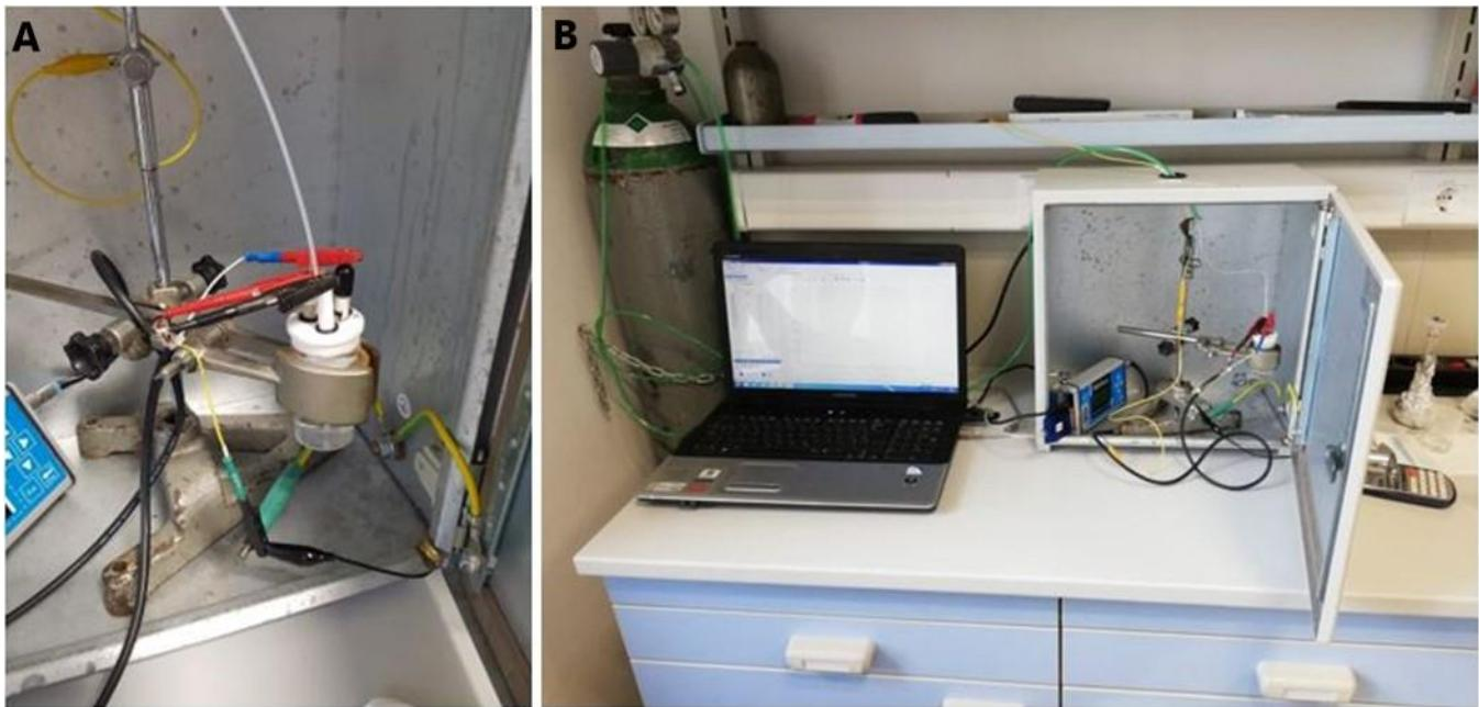
Slika 16. A) Troelektrodna voltametrijska ćelija, B) PalmSens potenciostat/galvanostat.
