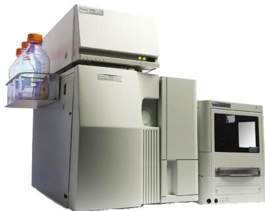
Slika 5. Prikaz uređaja tekućinske kromatografije visoke razlučivosti (HPLC) [25].
