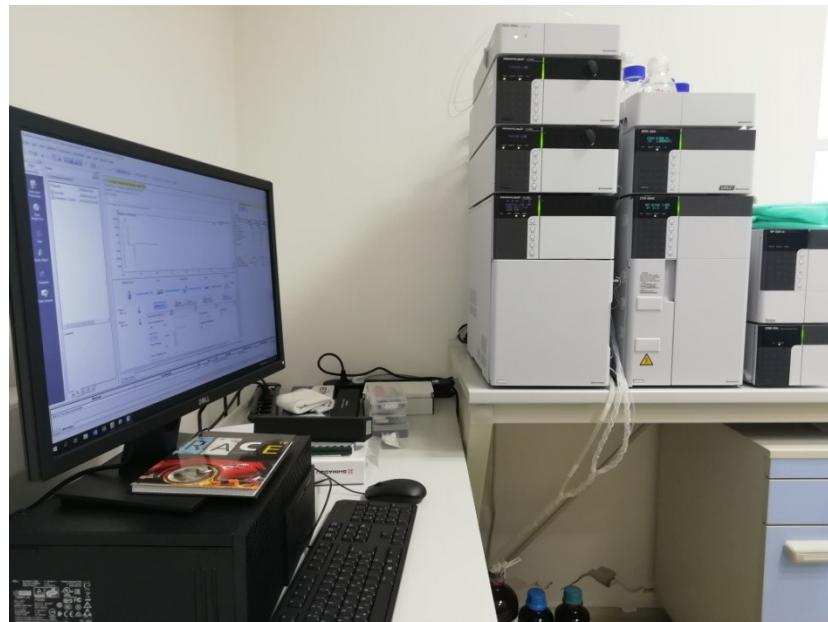
Slika 11. Tekućinski kromatograf visoke razlučivosti.
