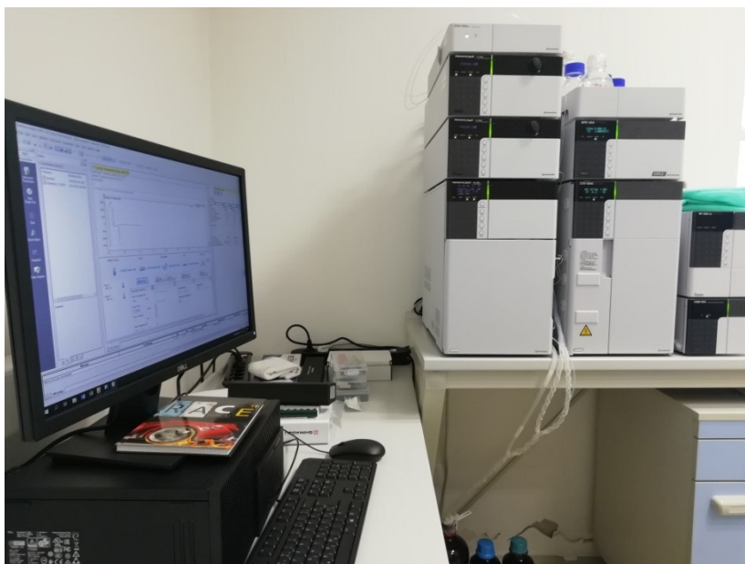
Slika 11. Tekućinski kromatograf visoke razlučivosti.
