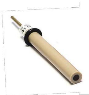
**Slika 26.** Radna elektroda od staklastog ugljika (GC-elektroda).
