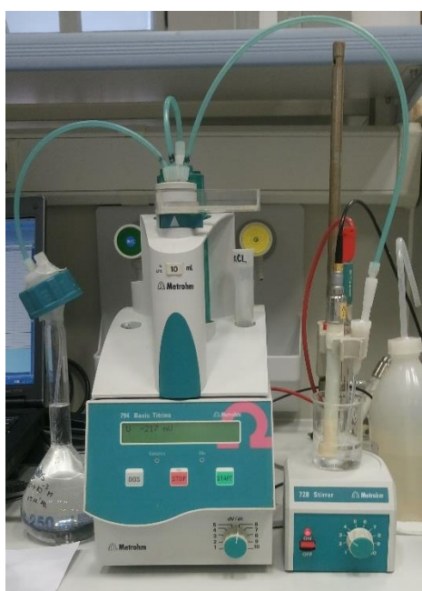
Slika 9. Automatski univerzalni titrator 794 Basic Titrino i pripadajuća jedinica za doziranje 806 Exchange Unit te magnetska mješalica 728 Stirer
