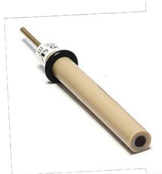
Slika 7. Radna elektroda od staklastog ugljika.
