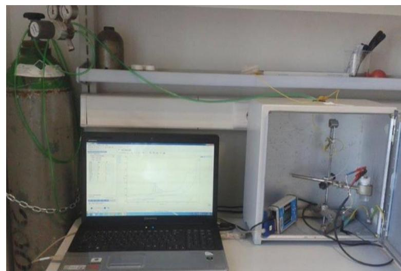
Slika 10. Aparatura za voltametrijska mjerena.
