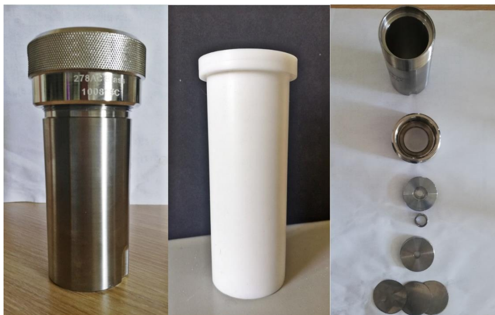
Slika 15. Prikaz korištenog autoklava i njegovi sastavni dijelovi.
