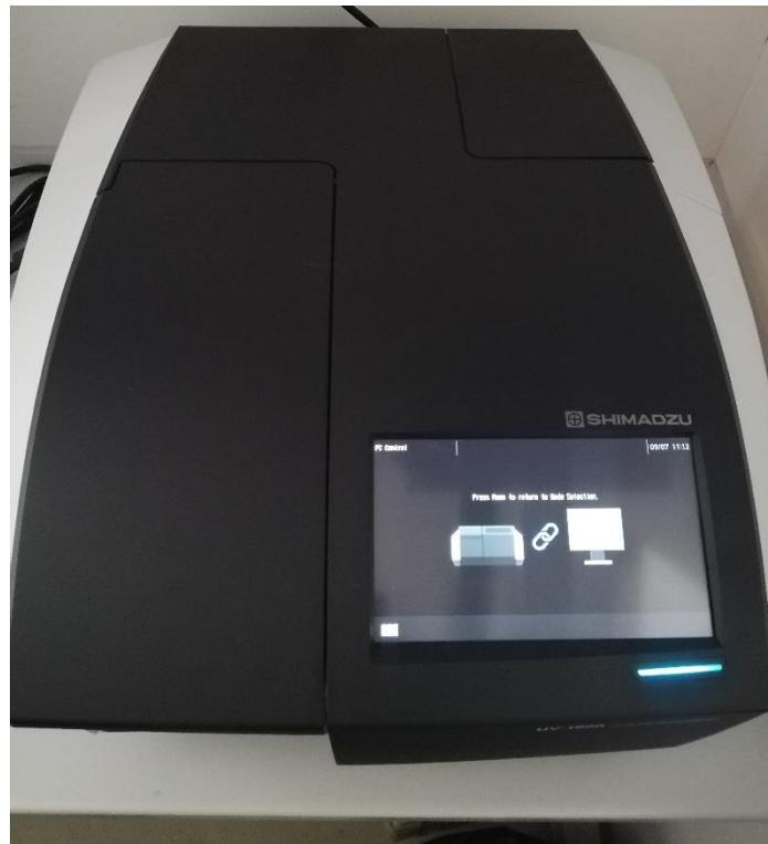
Slika 19. UV-1900 spektrofotometar.
