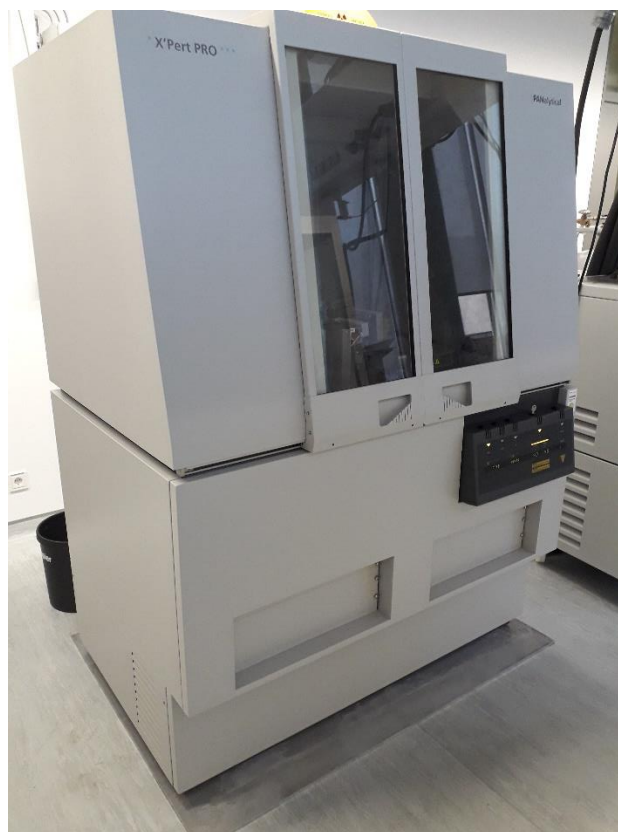
Slika 10. Panalytical X'Pert Pro difraktometar.
