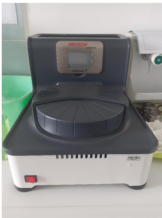
Slika 6. Planetarni kuglični mlin.
