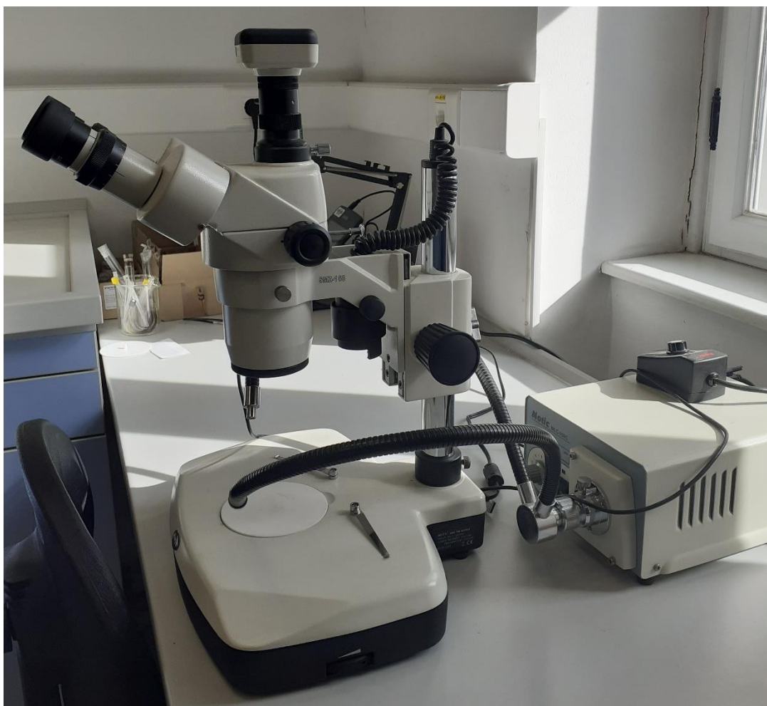
Slika 13. Optički mikroskop korišten za proučavanje nastalih kristala.
