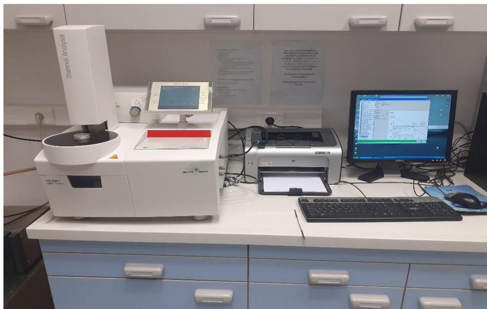
**Slika 18.** TGA-DSC Mettler Toledo System 1 uređaj.
