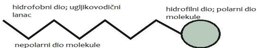
Slika 1. Shema molekule tenzida
