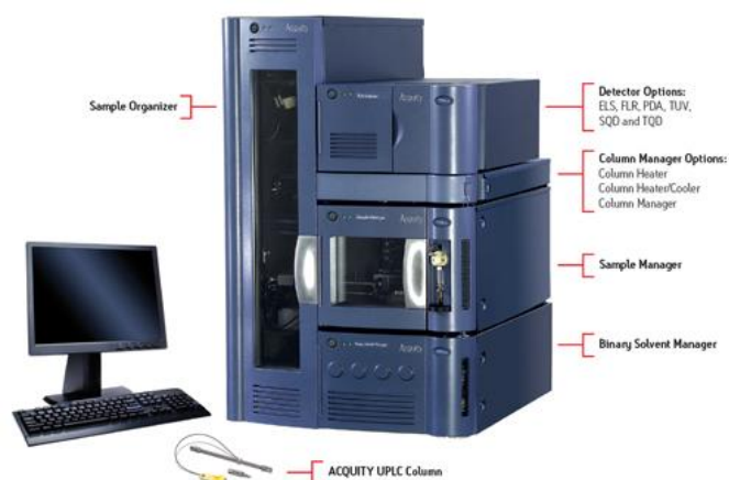
Slika 6: Uređaj za UPLC analizu [18]
