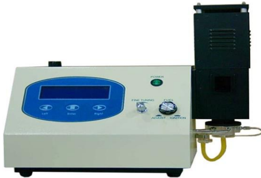
Slika 18. Instrument za plamenu emisijsku spektroskopiju [38]
