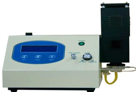
Slika 18. Instrument za plamenu emisijsku spektroskopiju [38]
