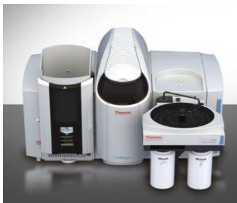
Slika 12. Uređaj za mjerenje atomskom apsorpcijskom spektroskopijom [16]
