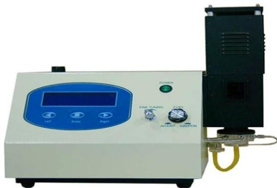
*Slika 18. Instrument za plamenu emisijsku spektroskopiju [38]*
