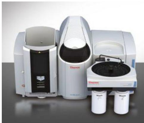
Slika 12. Uređaj za mjerjenje atomskom apsorpcijskom spektroskopijom [16]
