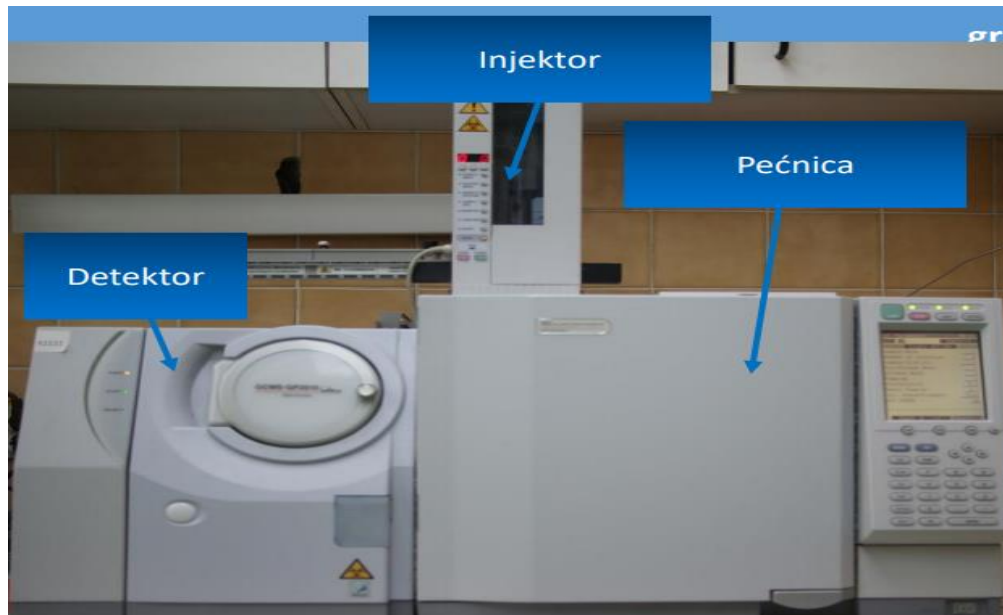
Slika 3. Prikaz plinskog kromatografa [6].
