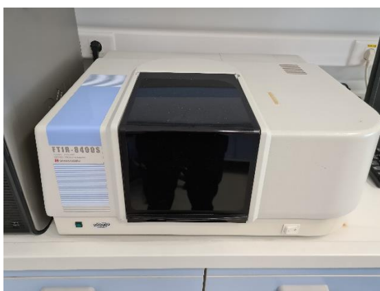
Slika 8: Spektroskop Shimadzu FTIR 8400S.
