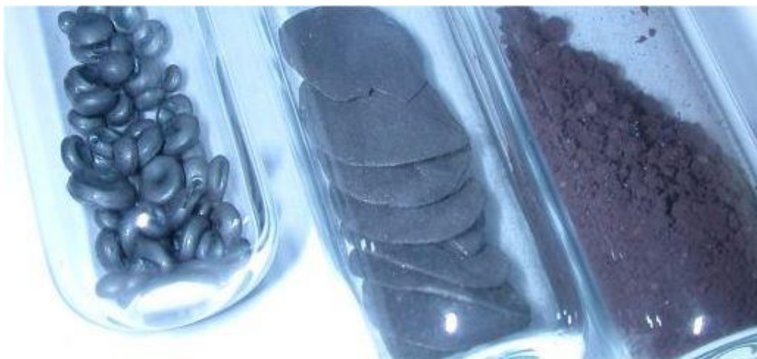
Slika 2. Alotropske modifikacije selenija: sivi, crni i crveni selenij [3]
