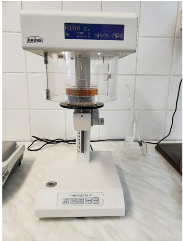
Slika 8. Mjerenje površinske napetosti uređajem Krüss K9.
