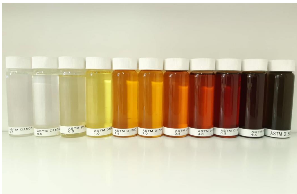
Slika 4. Ispitivana ulja složena po boji koja je određena ASTM metodom.
