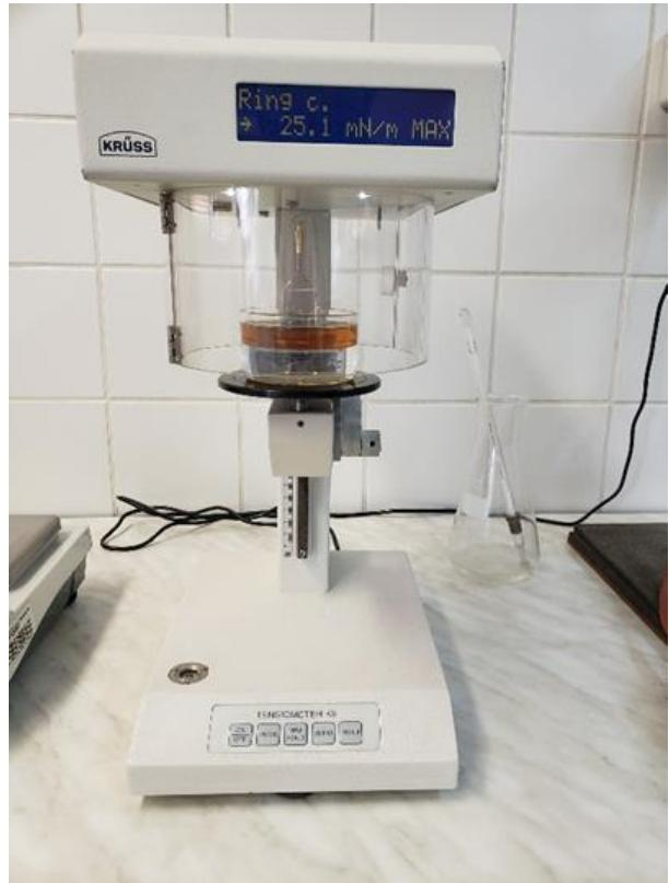
Slika 8. Mjerenje površinske napetosti uređajem Krüss K9.
