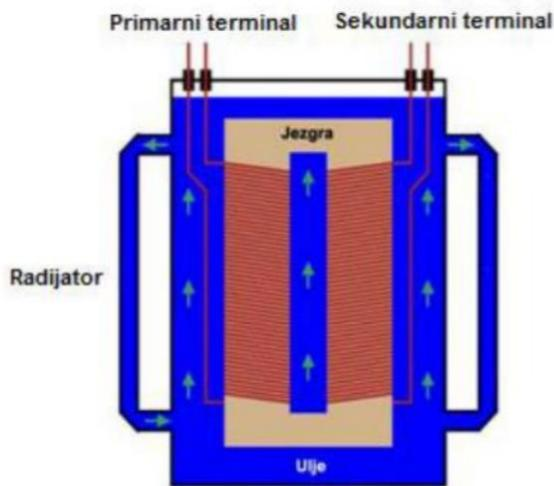
Slika 2. Prikaz strujanja ulja u transformatoru. [6]
