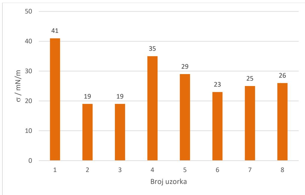
Slika 10. Grafički prikaz površinske napetosti ispitivanih uzoraka ulja.
