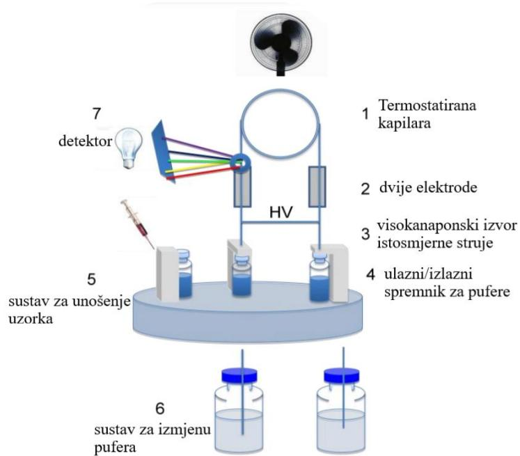
Slika 6. Shematski prikaz uređaja za kapilarnu elektroforezu [17].
