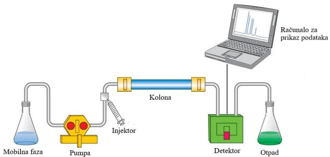
Slika 2. Shematski prikaz tekućinske kromatografije visoke djelotvornosti [8].
