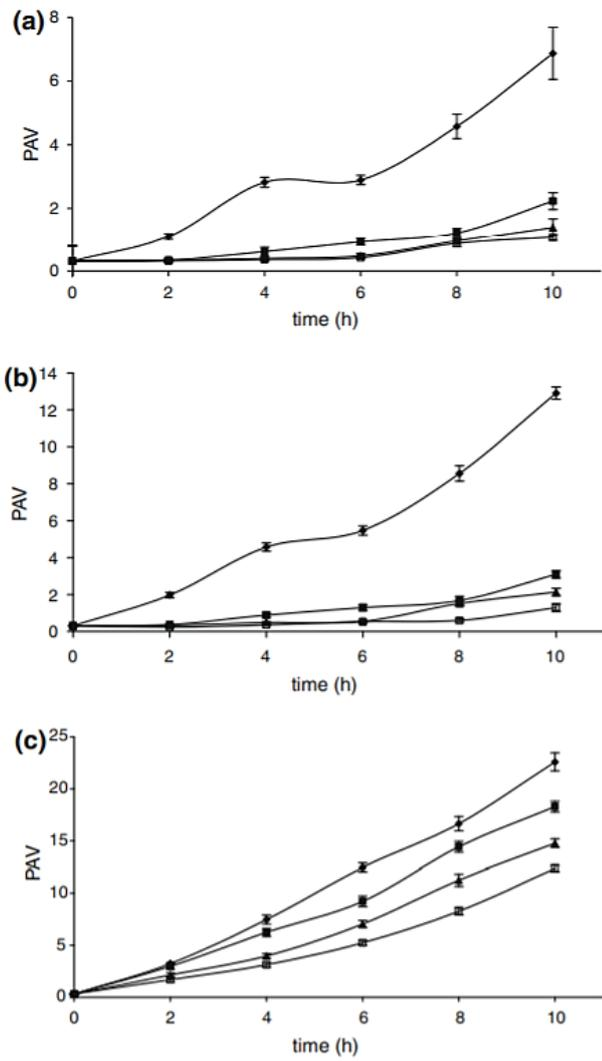
Slika 10: Vrijednost p-anisidina nastalog oksidacijom uz dodatak sezamola [19].
