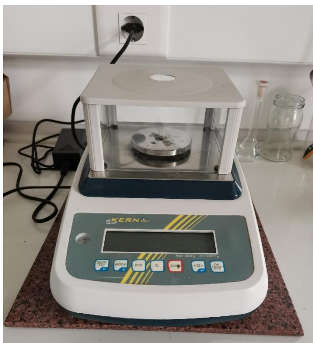
Slika 14: Analitička vaga pomoću koje su se vagali uzorci žumanjka.
