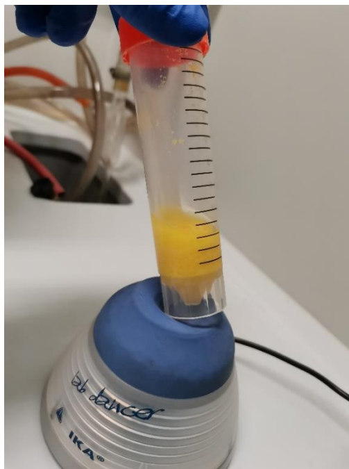
Slika 17: Miješanje sadržaja kivete laboratorijskom treskalicom.
