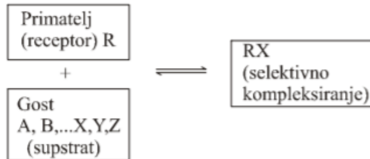
Slika 14. Molekulsko/ionsko prepoznavanje primatelja s određenom ionskom vrstom u otopini analita [8].
