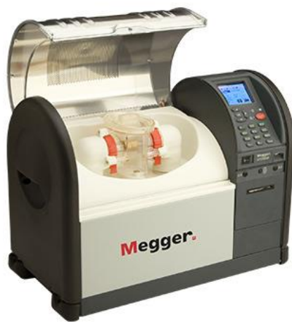
Slika 11. uređaj za određivanje probojnog napona [34].
