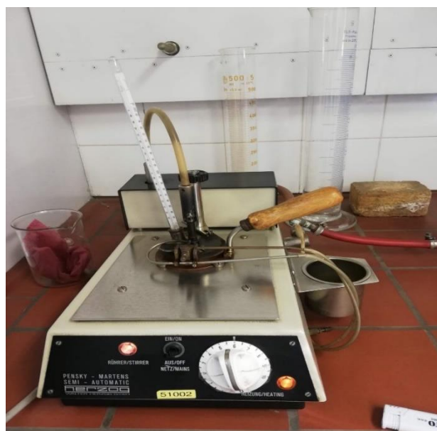
Slika 9. Uređaj za određivanje točke paljenja
