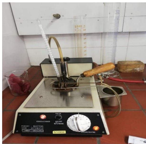
Slika 9. Uređaj za određivanje točke paljenja
