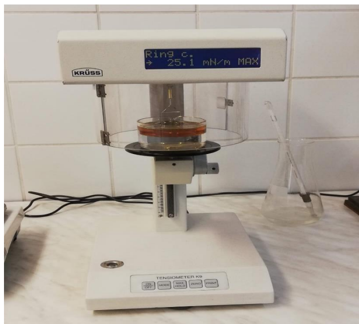
Slika 8. Uređaj za određivanje površinske napetosti
