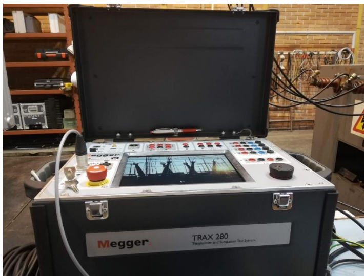
Slika 13. Uređaj za određivanje \tan \delta .
