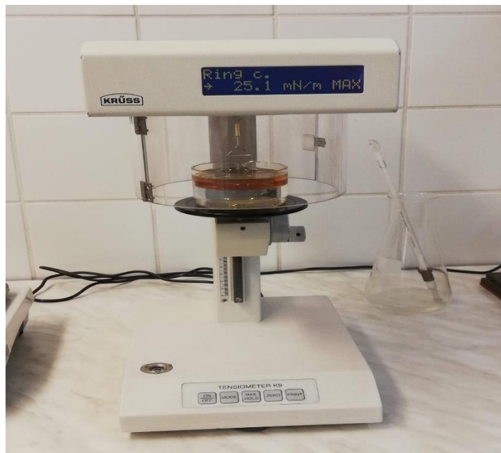
Slika 8. Uređaj za određivanje površinske napetosti
