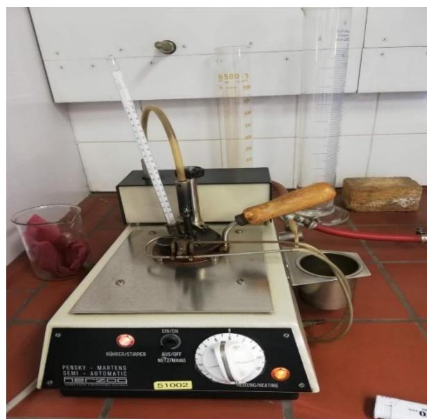
Slika 9. Uređaj za određivanje točke paljenja
