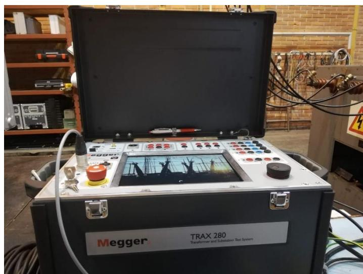
Slika 13. Uređaj za određivanje  $\tan \delta$ .
