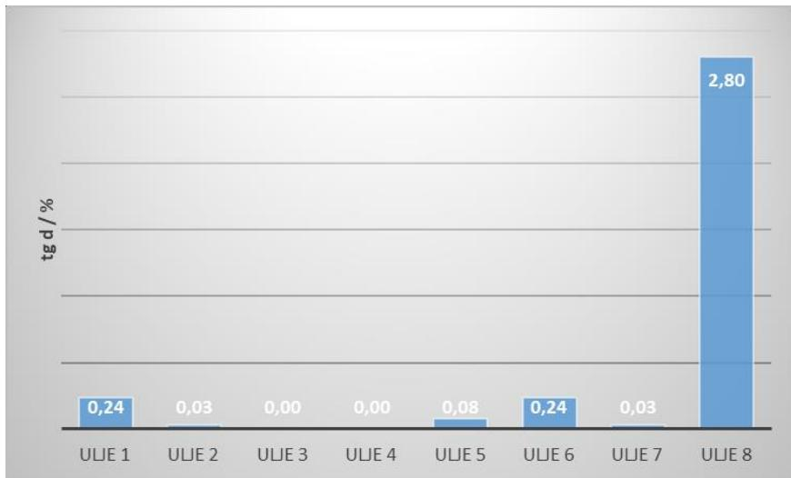
Slika 16. Grafički prikaz ispitivanja koeficijenta dielektričnih gubitaka.
