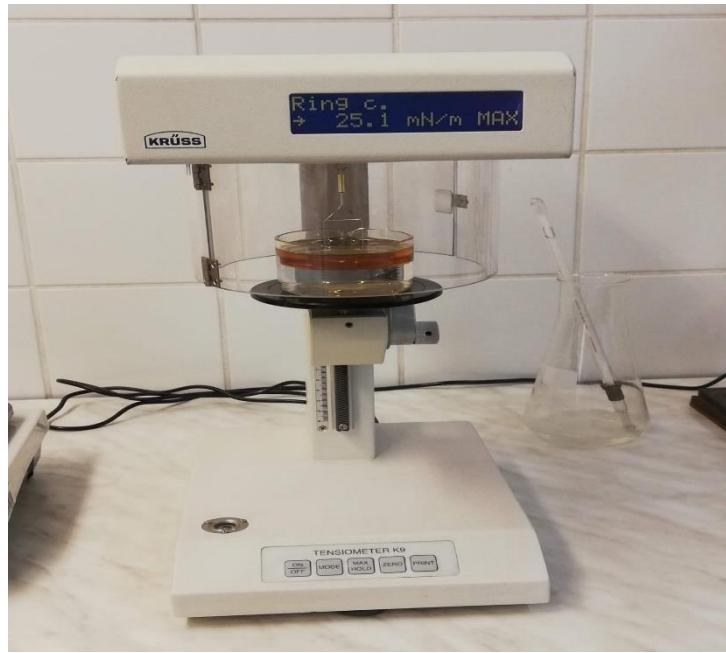
Slika 8. Uređaj za određivanje površinske napetosti
