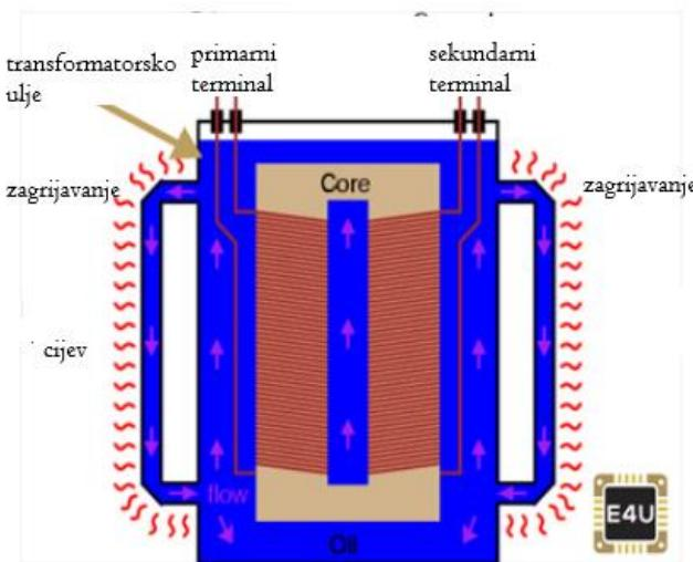
Slika 3. strujanje ulja u transformatoru [11].
