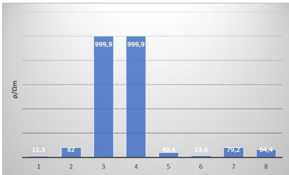
Slika 17. Grafički prikaz ispitivanja specifičnog otpora ulja.
