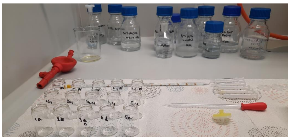
Slika 12. Priprema uzoraka za filtraciju
