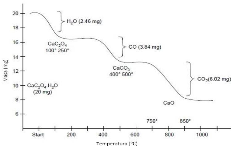
Slika 27. Termogravimetrijska krivulja kalcijeva oksalata monohidrata [63].
