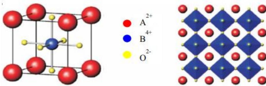
*Slika 7. Idealna kubična perovskitna struktura ( $\text{ABO}_3$ ) [6].*
