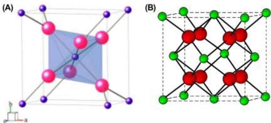
*Slika 2. A) Struktura rutila (tip  $TiO_2$ ) s  $M^{4+}$  kationom okruženim heksakoordiniranim kisikovim anionima u oktaedarskoj jedinici; B) Struktura fluorita s  $M^{4+}$  kationima koji tvore kubično plošno centriranoj celiju s kisikovim anionima koji se nalaze u sredini svakog oktanta [1].*
