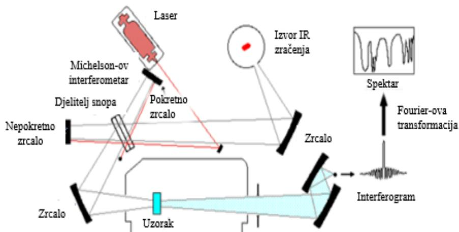
Slika 25. Shematski prikaz modernog FT-IR spektrofotometra [59].
