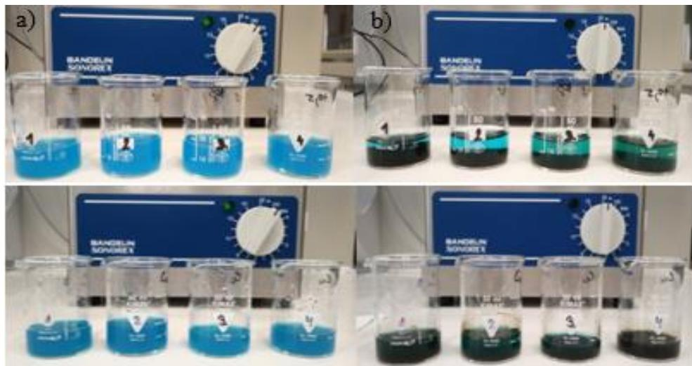
*Slika 40. a) Dvije serije otopina prije ultrazvučne sinteze; b) Otopine nakon ultrazvučne sinteze od 15, 30, 45, 60, 75, 90, 105 i 120 min.*
