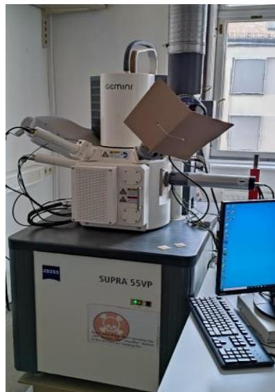
*Slika 50. Zeiss Supra 55 VP SEM uređaj.*
