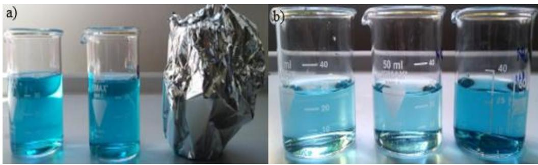
*Slika 82. a) Serija otopina metilen plavog s dodatkom CuH1 uzorka prije mjerena fotokatalitičke aktivnosti; b) Serija otopina metilen plavog s dodatkom CuH1 uzorka nakon mjerena fotokatalitičke aktivnosti u trajanju od 150 min.*
