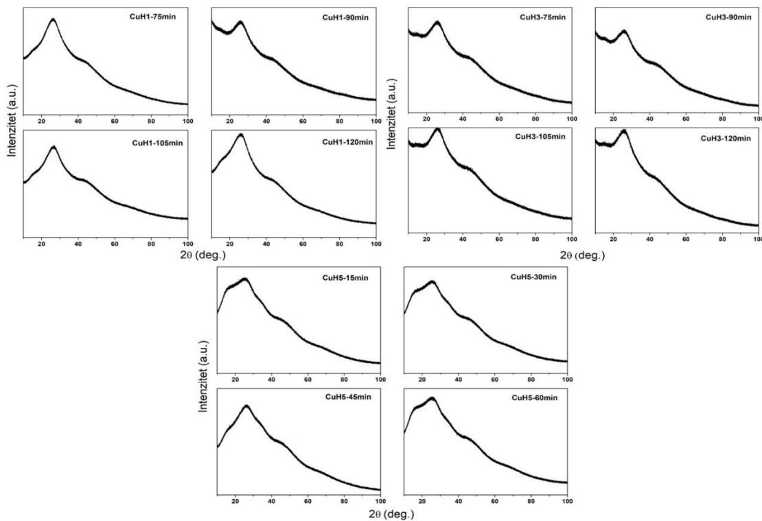
*Slika 57. Difraktogrami uзорака CuH1, CuH3 и CuH5 sintetizirani u ultrazvučnoj kupelji na različitim vremenima (75, 90, 105, 120 min).*
