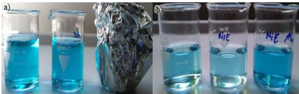
*Slika 85. a) Serija otopina metilen plavog s dodatkom NiE uzorka prije mjerena fotokatalitičke aktivnosti; b) Serija otopina metilen plavog s dodatkom NiE uzorka nakon mjerena fotokatalitičke aktivnosti u trajanju od 150 min.*
