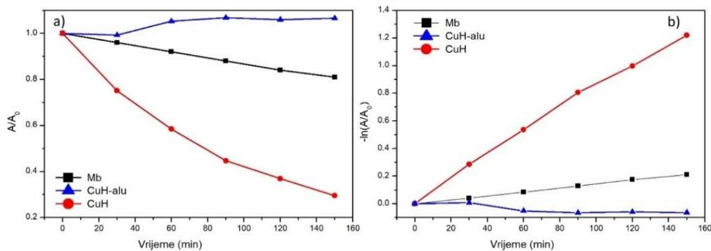
*Slika 86. a) Ovisnost promjene apsorbancije u vremenu za fotolizu metilen plavog (—), uz dodani uzorak CuH na svjetlu (—), uz dodani uzorak CuH u foliji (—) b) graf kinetike prvog reda za fotolizu metilen plavog (—), uz dodani uzorak CuH na svjetlu (—), uz dodani uzorak CuH u foliji (—).*
