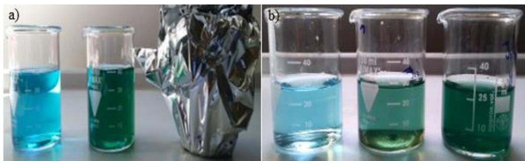
*Slika 83. a) Serija otopina metilen plavog s dodatkom CuE uzorka prije mjerena fotokatalitičke aktivnosti; b) Serija otopina metilen plavog s dodatkom CuE uzorka nakon mjerena fotokatalitičke aktivnosti u trajanju od 150 min.*
