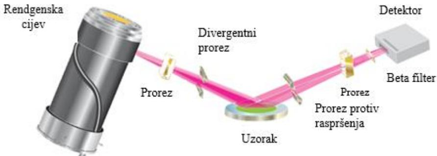
*Slika 31. Klasični difraktometar praha u Bragg-Brentano geometriji ili refleksijskoj geometriji s komponentama za mjerjenje refleksije [64].*
