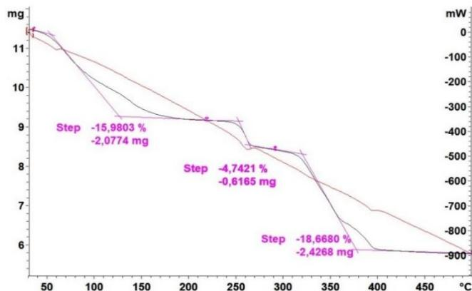
*Slika 78. Termogravimetrijska analiza NiE uzorka prije kalcinacije.*
