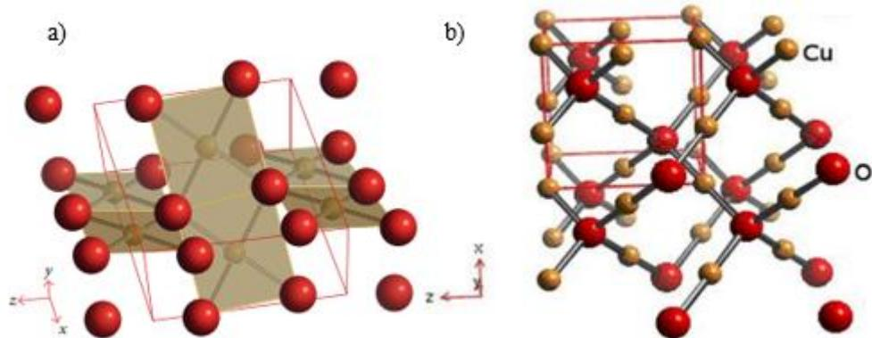
Slika 16. a) Kristalna struktura CuO; b) Kristalna struktura Cu<sub>2</sub>O [38,42].
