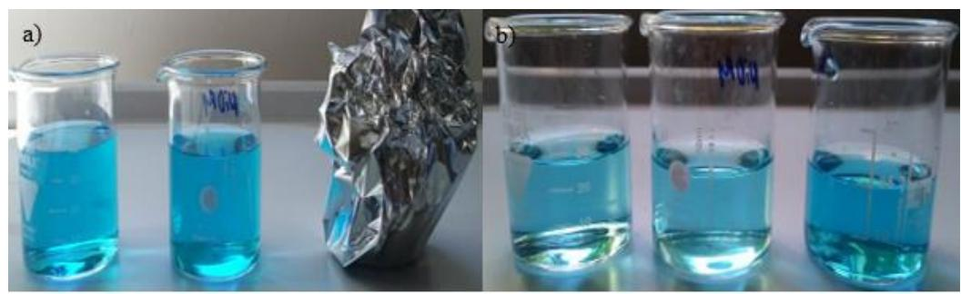
*Slika 84. a) Serija otopina metilen plavog s dodatkom NiH uzorka prije mjerena fotokatalitičke aktivnosti; b) Serija otopina metilen plavog s dodatkom NiH uzorka nakon mjerena fotokatalitičke aktivnosti u trajanju od 150 min.*
