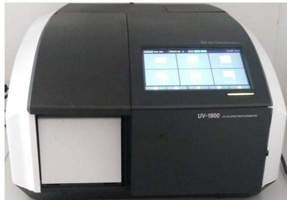
Slika 47. Shimadzu UV 1900 UV/VIS spektrofotometar.
