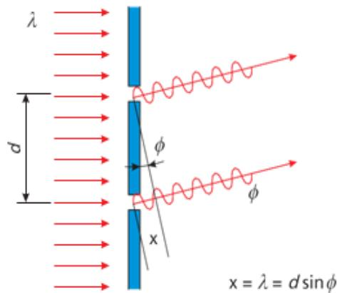
*Slika 29. Konstruktivna interferencija na rešetki (vidljivo svjetlo) [64].*
