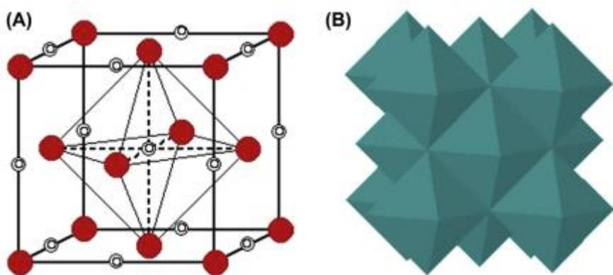
*Slika 1. A) Struktura NaCl-a s oktaedarskom jedinicom: crveni krugovi prikazuju kisikove atome, a dupli otvoreni krugovi prijelazne metale; B)  $MO_6$  oktaedar nastao dijeljenjem kuta kisikovih iona [1].*
