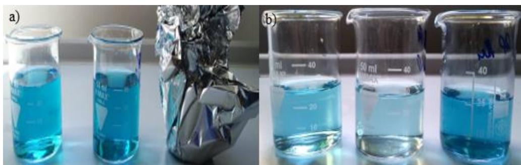
Slika 81. a) Serija otopina metilen plavog s dodatkom CuH uzorka prije mjerena fotokatalitičke aktivnosti; b) Serija otopina metilen plavog s dodatkom CuH uzorka nakon mjerena fotokatalitičke aktivnosti u trajanju od 150 min.
