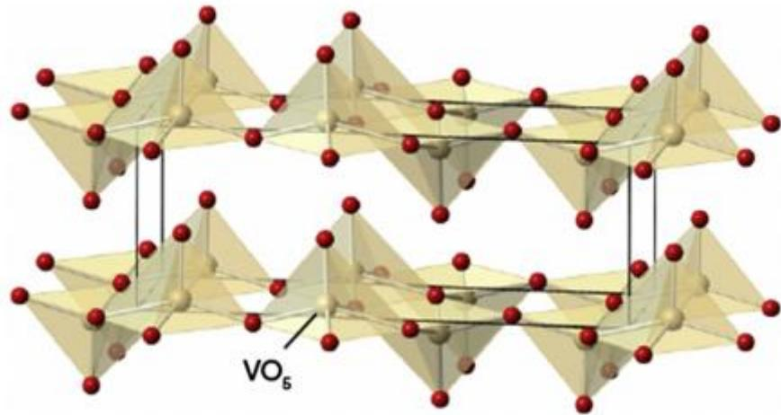
*Slika 5. Slojevita rompska struktura vanadijevog pentoksida ( $V_2O_5$ ) s gore-dolje izmjeničnim  $VO_5$  kvadratnim piramidama [4].*
