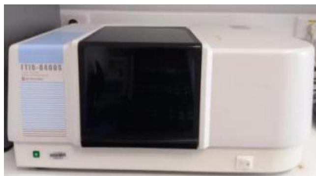
*Slika 45. Shimadzu FT-IR 8400S spektrometar.*
