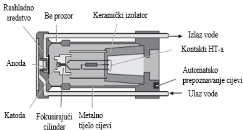
*Slika 28. Shematski prikaz zatvorene rendgenske cijevi [65].*
