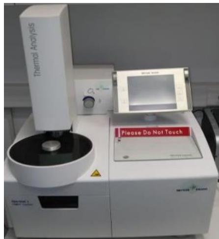
Slika 46. Mettler Toledo TGA/DSC uređaj.
