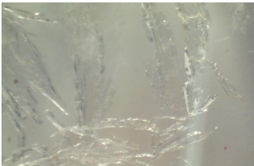
Slika 20. Jedinični kristal spoja Do3OH pripremljen metodom isparavanja uz otapalo benzen
