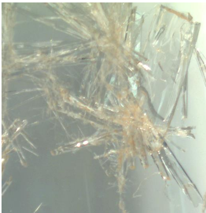
Slika 38. Igličasti sraslaci spoja Do4OH pripravljeni metodom evaporacije uz otapalo kloroform
