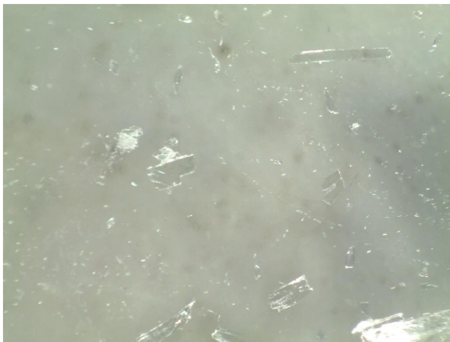
Slika 45. Pločasti kristali spoja Dp5OH pripravljeni metodom evaporacije uz otapalo etanol
