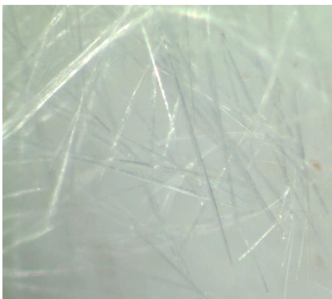
Slika 39. Igličasti kristali spoja Do4OH pripravljeni metodom evaporacije uz otapalo cikloheksan
