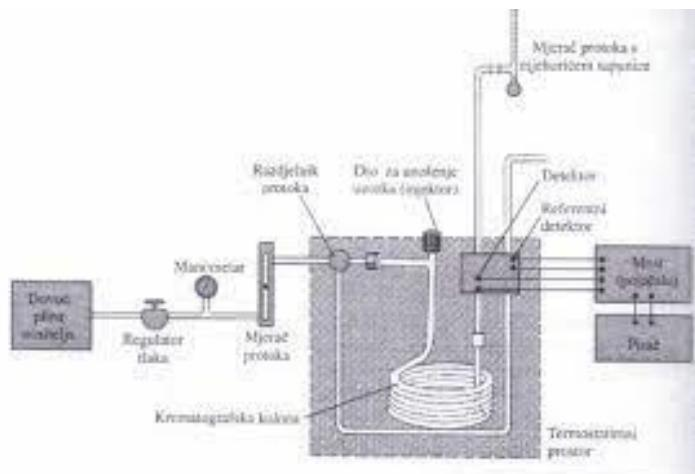
Slika 2: Shematski prikaz plinsko-tekućinskog kromatografa [12].
