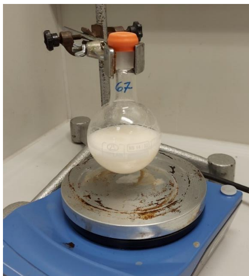
Slika 10. Aparatura za sintezu 1,3-dioktadecil-1 H -imidazol-3-ijeva tetrafenilborata ( 67 )
