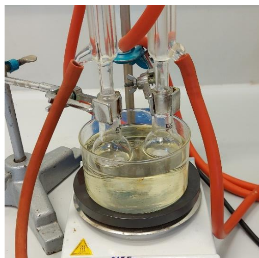
Slika 9. Aparatura za sintezu 1,3-diikosil-1 H -imidazol-3-ijeva bromida (57), 1,3-dioktadecil-1 H -imidazol-3-ijeva bromida (58), 1,3-dioktadecil-1 H -imidazol-3-ijeva jodida (59) i 4-metil-1,3-dioktadecil-1 H -imidazol-3-ijeva bromida (60)
