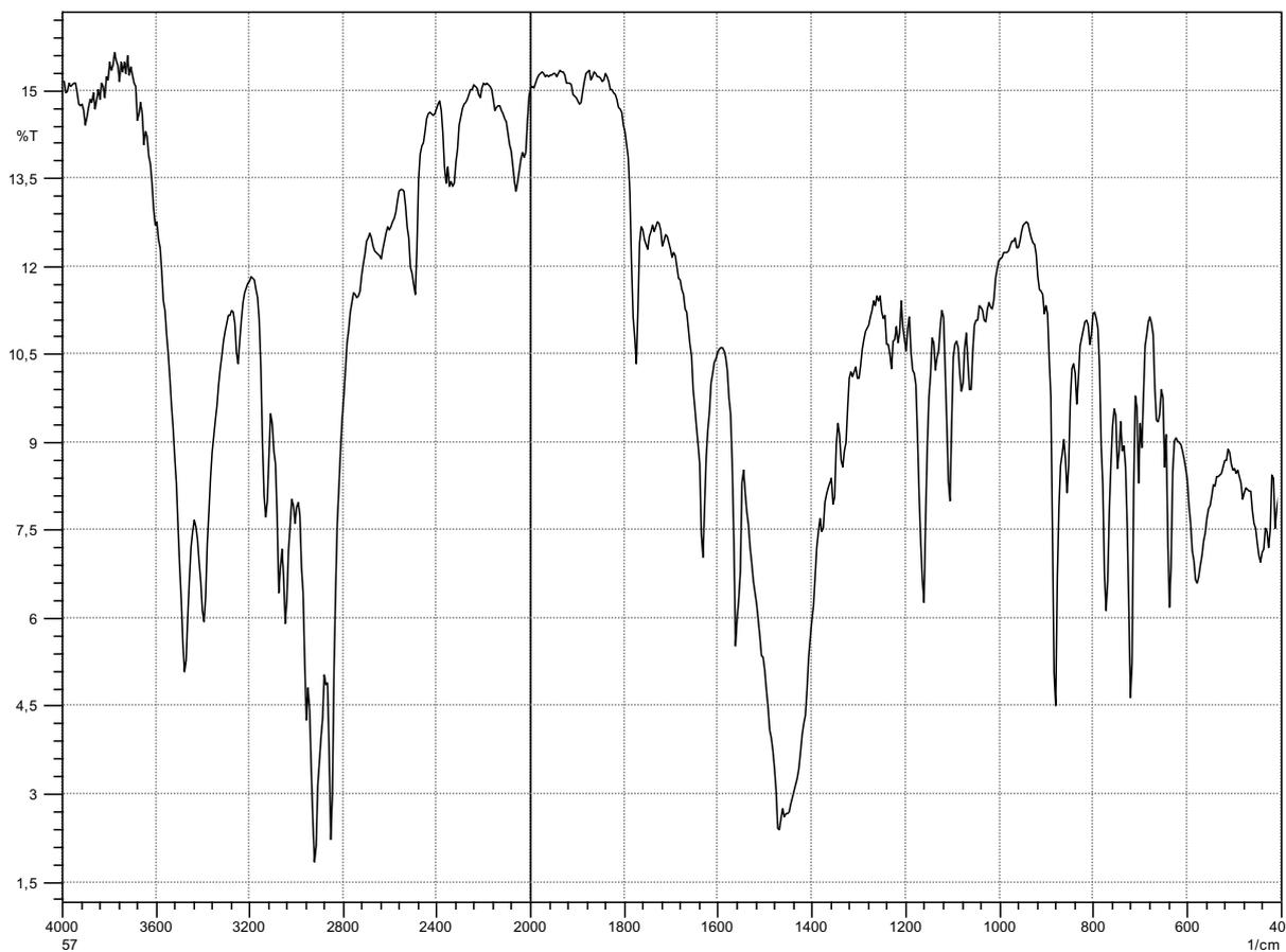
Slika 30. IR spektar 1,3-diikosil-1*H*-imidazol-3-ijeva bromida (**57**)
