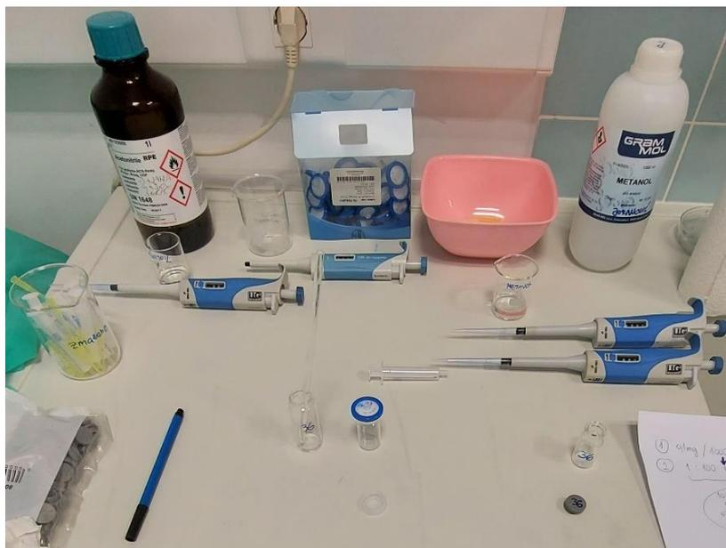
Slika 15. Pribor potreban za pripremu uzorka za MS analizu
