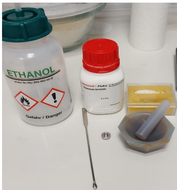
Slika 14. Pribor potreban za pripremu uzorka za IR analizu
