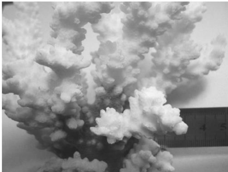
Slika 6. Optička fotografija koja prikazuje poroznu morfologiju koralja. [2]
