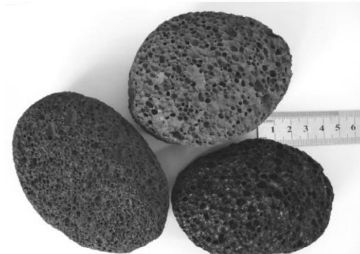
Slika 7. Slika koja prikazuje poroznu morfologiju plavca. [2]
