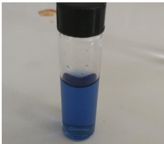
Slika 21. pripremljeni P8* hidrogel u 1M HCl-u uz dodatak TPTZ-a
