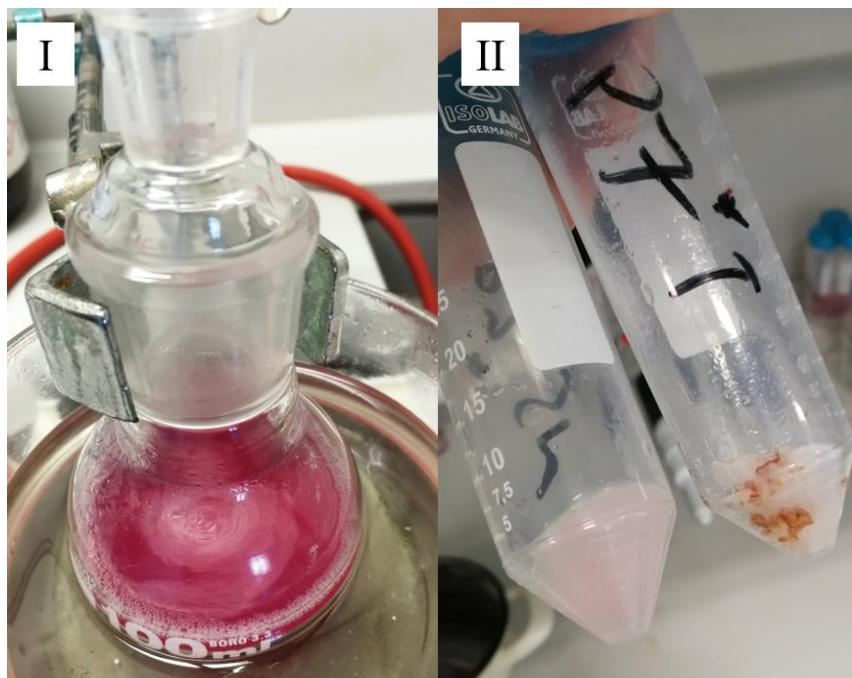
Slika 12. priprema otopine P7 na refluksu (I); obojeni talog nakon neutralizacije i ispiranja (II)
