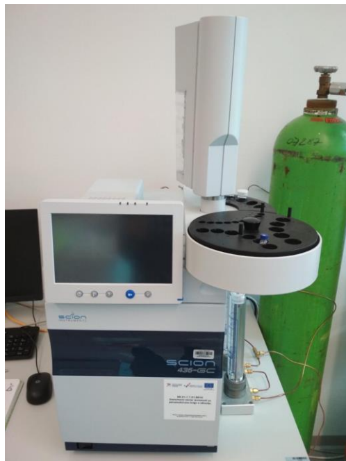
Slika 43. Plinski kromatograf na kojem su analizirani uzorci hrane
