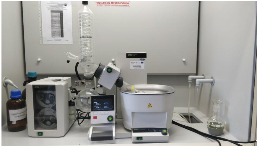
Slika 32. Uparavanje uzorka na rotacijskom uparivaču
