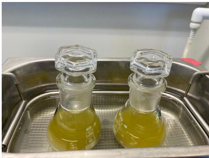
Slika 38. Indirektna ultrazvučna ekstrakcija uzoraka
