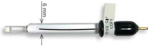
**Slika 11.** Referentna elektroda – Ag/ AgCl elektroda (unutrašnji elektrolit je KCl ( $c = 3 \text{ mol dm}^{-3}$ ) [46].
