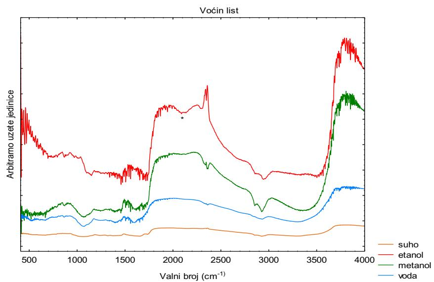
Slika 18. FTIR spektri listova imele s područja Voćina (etanol, metanol i voda u usporedbi sa suhim uzorkom)
