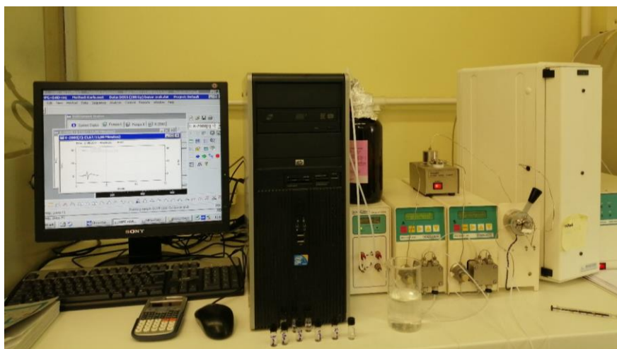
Slika 6. HPLC + DAD instrument korišten za analizu ozračenih uzoraka.
