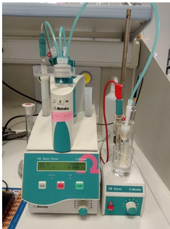
Slika 15. Sustav za potenciometrijska mjerenja.
