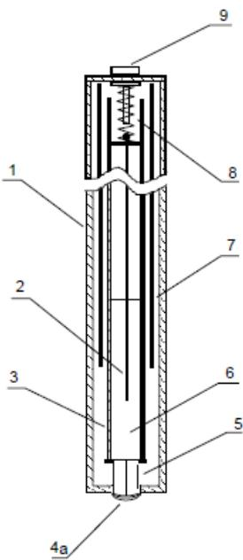
Slika 13. Ionsko-selektivna elektroda s tekućom membranom, 1 - tijelo elektrode, 2 – Ag | AgCl žica, 3 - tijelo unutarnje referentne elektrode, 4a - PVC membrana, 5 – nosač membrane (brtva), 6 - unutarnji elektrolit, 7 - čelični oklop, 8 – spoj s referentnom elektrodom, 9 – konektor [24].
