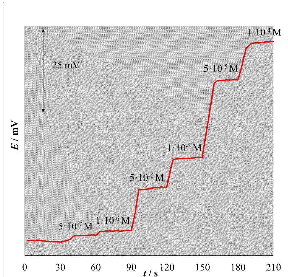
Slika 18. Dinamički odziv TBZ-SAL senzora prema TBZ-u.
