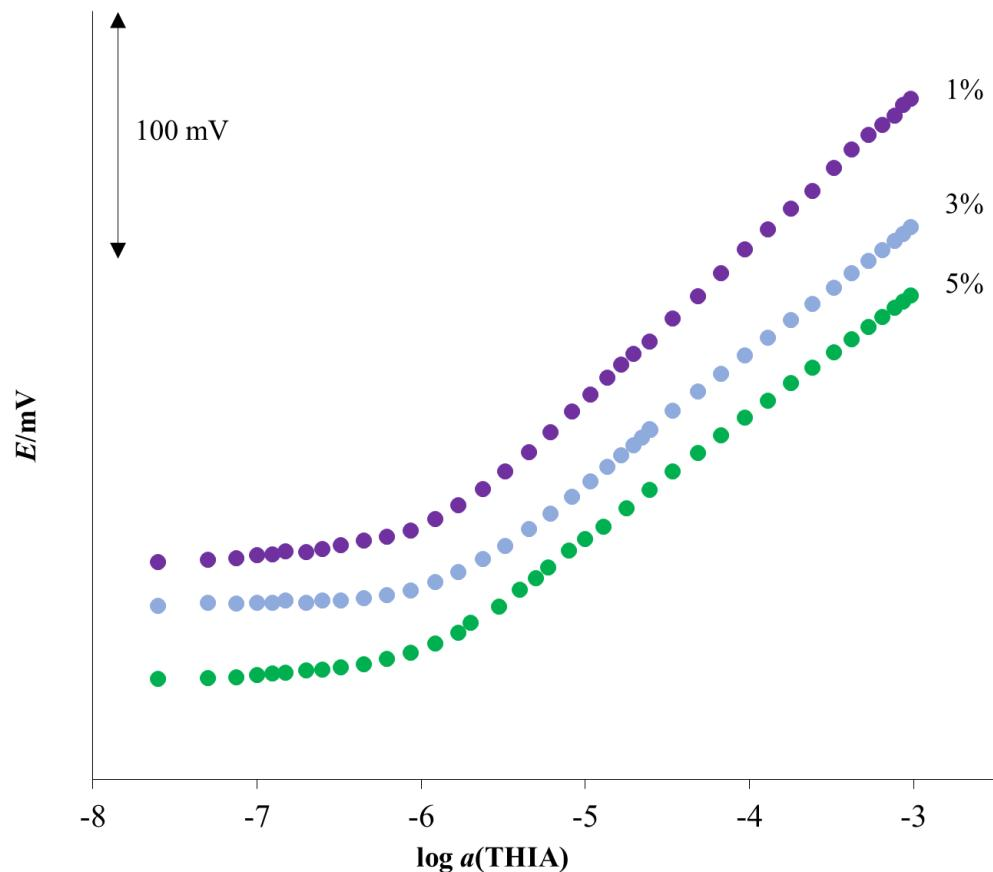
Slika 17. Odzivne karakteristike TBZ-SAL senzora s različitim postotkom senzorskog materijala prema TBZ-u.
