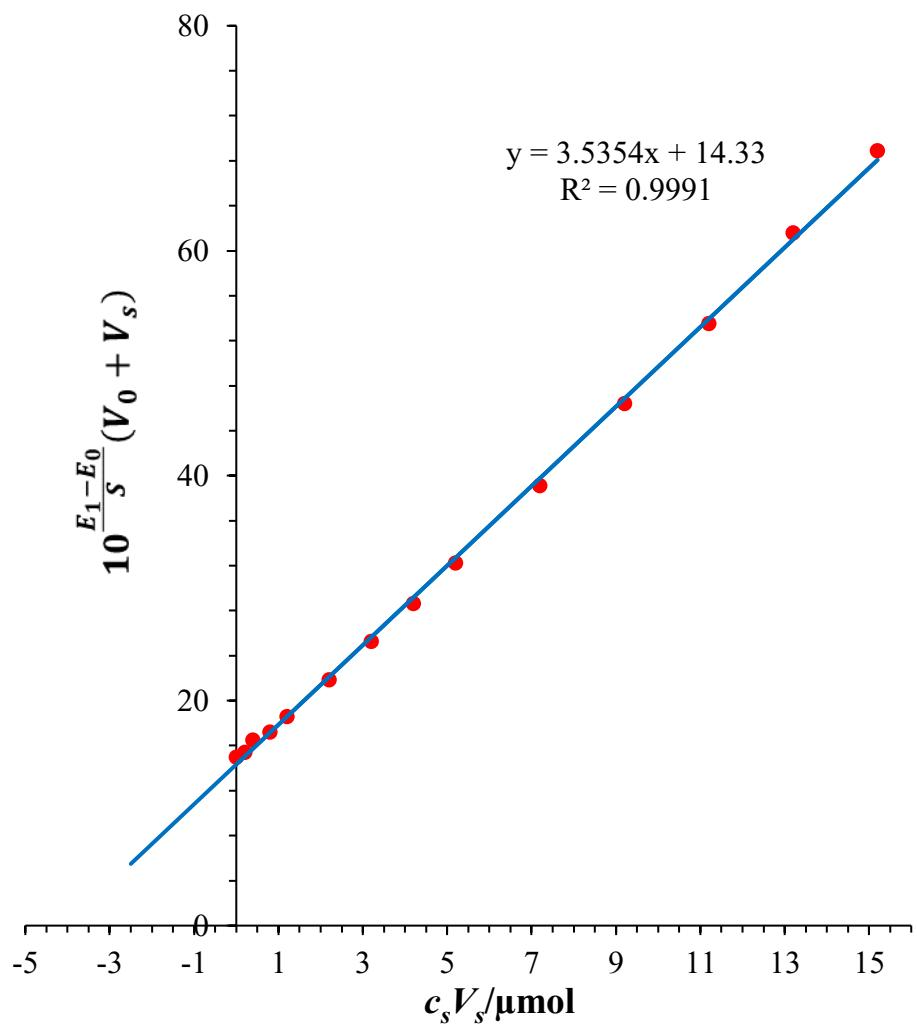
Slika 20. Kalibracijski pravac dobiven određivanjem TBZ-a u narančinoj kori Granovom metodom.
