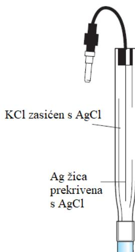
Slika 10. Zasićena srebro/srebrov klorid elektroda [19].
