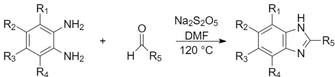
Slika 5. Sinteza supstituiranih derivata TBZ-a iz *o*-fenilendiamina i tiazol-4-aldehyda [6].
