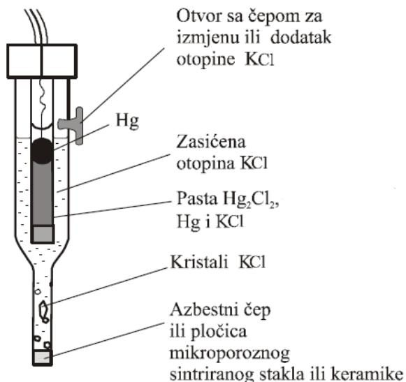
Slika 9. Zasićena kalomelova elektroda [20].
