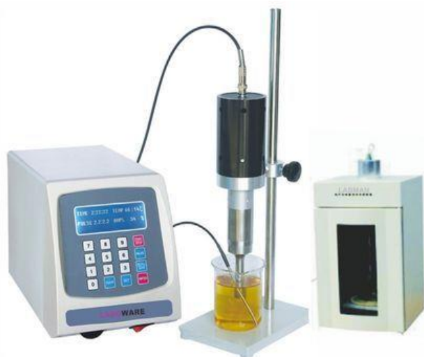
Slika 9. Prikaz aparature za ultrazvučnu ekstrakciju [36].
