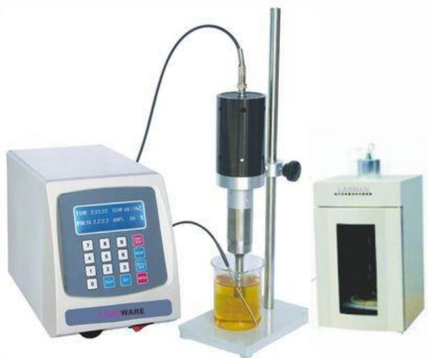
Slika 9. Prikaz aparature za ultrazvučnu ekstrakciju [36].
