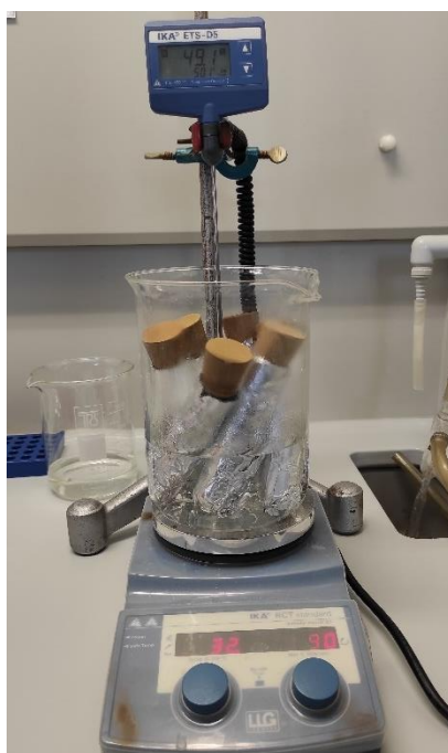
Slika 13. Zagrijavanje smjese u vodenoj kupelji.
