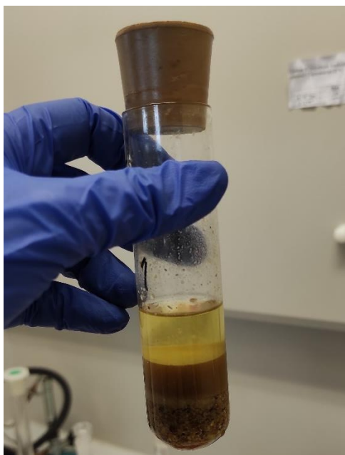
Slika 15. Odvajanje organskog sloja od vodenog sloja.
