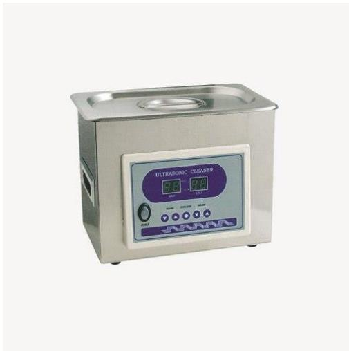
Slika 6. Ultrazvučna kupelj [32].
