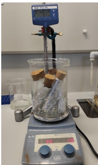
Slika 13. Zagrijavanje smjese u vodenoj kupelji.
