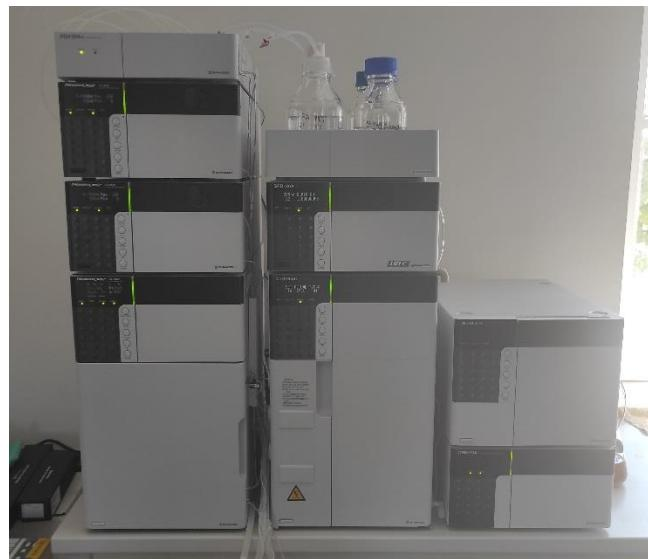
Slika 16. Tekućinski kromatograf visoke djelotvornosti.
