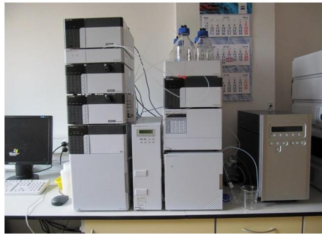
Slika 3. Uređaj za tekućinsku kromatografiju visoke djelotvornosti [26].
